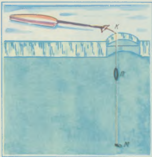
Рис. 9. Специальная снасть с кивком с большим углом изгиба: М — мормышка; П — поплавок; Х — кивок.
