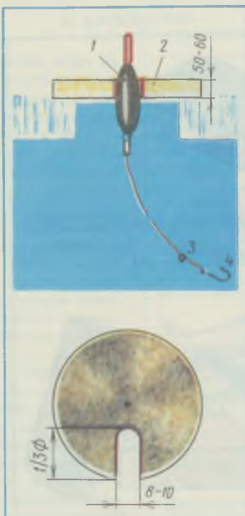
Кружок из пенопласта: 1 — поплавок; 2 — кружок; 3 — грузило; 4 — крючок.
